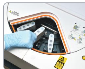
Автоматическое бесконтактное перемешивание реагента с парамагнитными частицами
