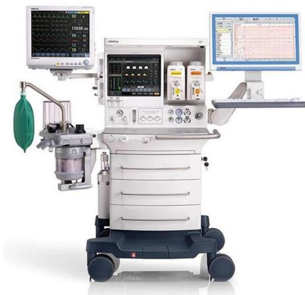
A7 от Mindray представляет собой анестезиологическую рабочую станцию, спроектированную по передовым инновационным технологиям специально для обеспечения непрерывной и максимально безопасной анестезии низкого потока, что, несомненно, дает возможность значительно сократить риски осложнений после перенесения анестезии.
