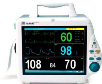
Mindray PM-8000 – портативный прикроватный монитор с большим TFT-дисплеем, системой внешнего питания и аккумуляторной перезаряжаемой батареей. Применяется для проведения обследований взрослых пациентов, детей и новорожденных. Работа в сети возможна совместно с главной центральной системой мониторинга Hypervisor VI. Данный аппарат легко поддается транспортировке благодаря небольшому весу (около 5 кг) и компактной продуманной конструкции.
